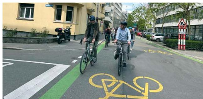
Fig. 2 – 4 : Les voies express cyclables sont idéalement aménagées sur des pistes cyclables en retrait ou sur des «rues cyclables» peu fréquentées par les véhicules à moteur (à gauche : large piste cyclable unidirectionnelle dans l'agglomération de Berne (Photo: OFROU); en haut à droite : «rue cyclable» à Winterthour (Photo: Kathrin Hager); en bas à droite : «Velovorzugsroute» Mühlebachstrasse à Zurich (Photo: Kontextplan).
