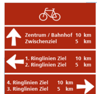
Abb. 8 Vorwegweiser bei Knotenpunkt
