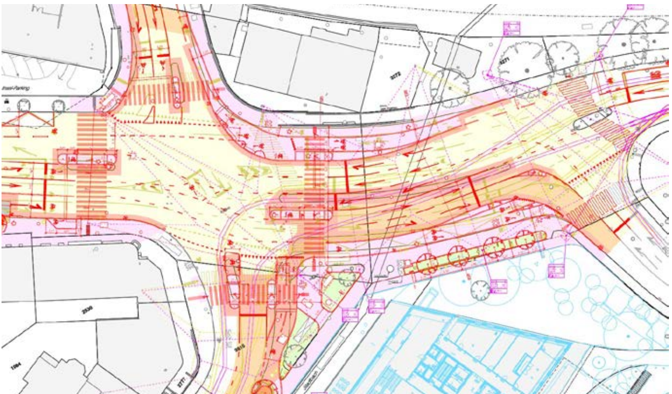
Fig. 2 Au centre du carrefour, les vélos circulent sur le côté droit, avec des bandes cyclables de 3 m de large pour répondre à la forte demande.
