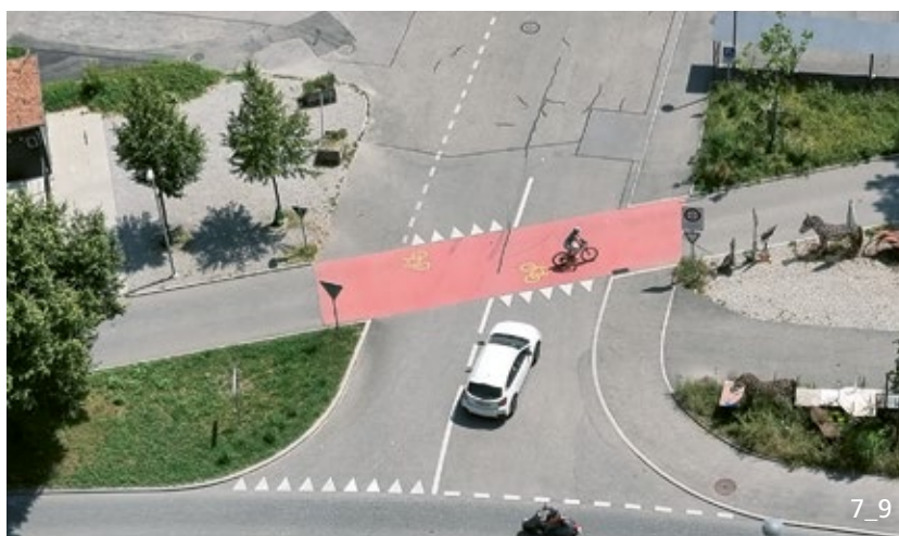
Franchissement cyclable prioritaire et en retrait d'un débouché (Sägegasse, Berthoud).
