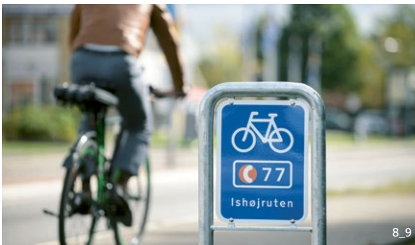
Routensignalisation einer Velobahn (Raum Kopenhagen, Dänemark) Hinweis: Das orange «C» wird auch auf der Fahrbahn zur besseren Erkennbarkeit der Linienführung markiert (in der Schweiz im Strassenverkehrsrecht nicht vorgesehen).
