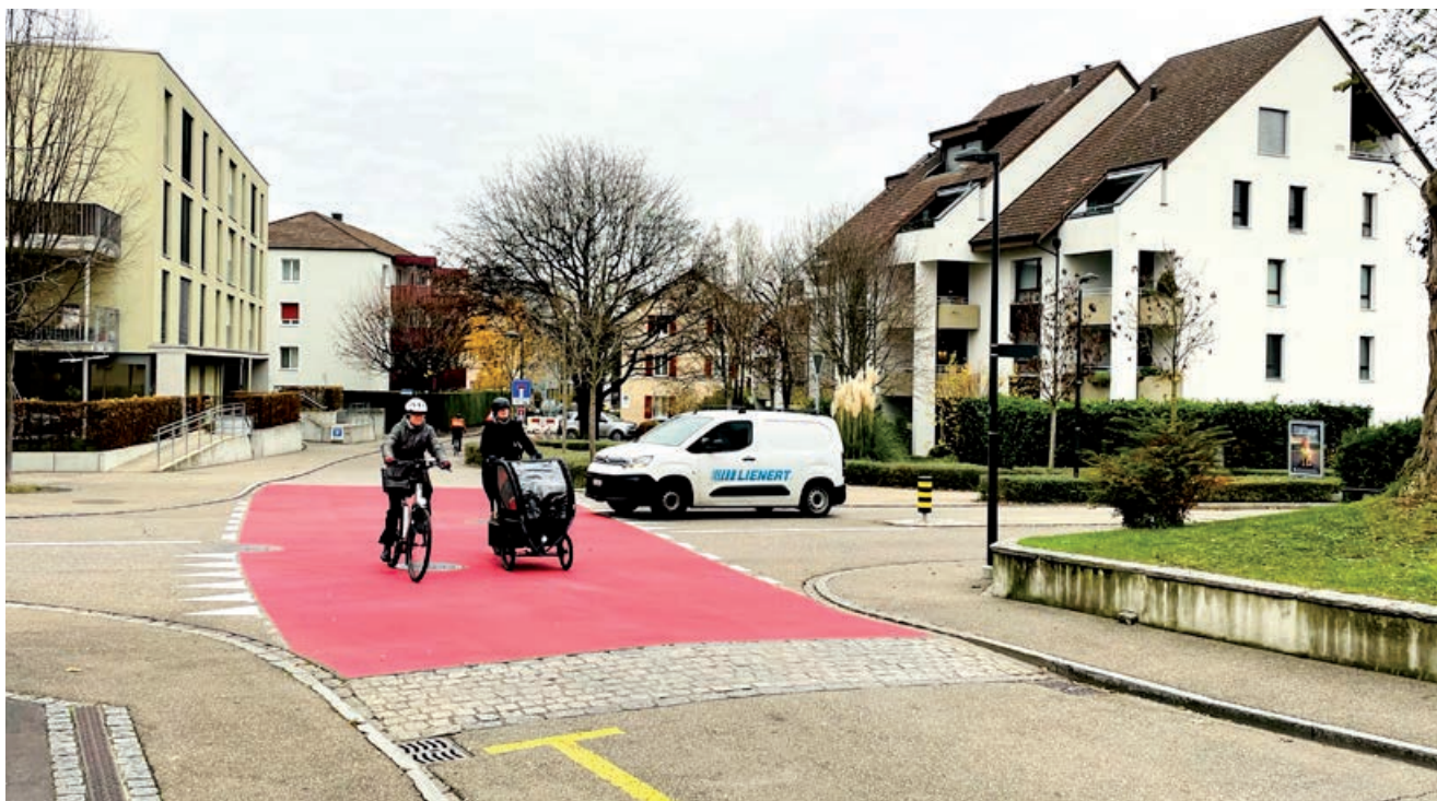
Cette voie express cyclable emprunte des routes secondaires limitées à 30 km/h et traverse plusieurs communes de l'agglomération de Bâle pour rejoindre le centre-ville. Aux carrefours, ces routes bénéficient de la priorité, ce qui permet aux cyclistes de circuler sans encombre et sans s'arrêter (photo : Laurent Dutheil)
