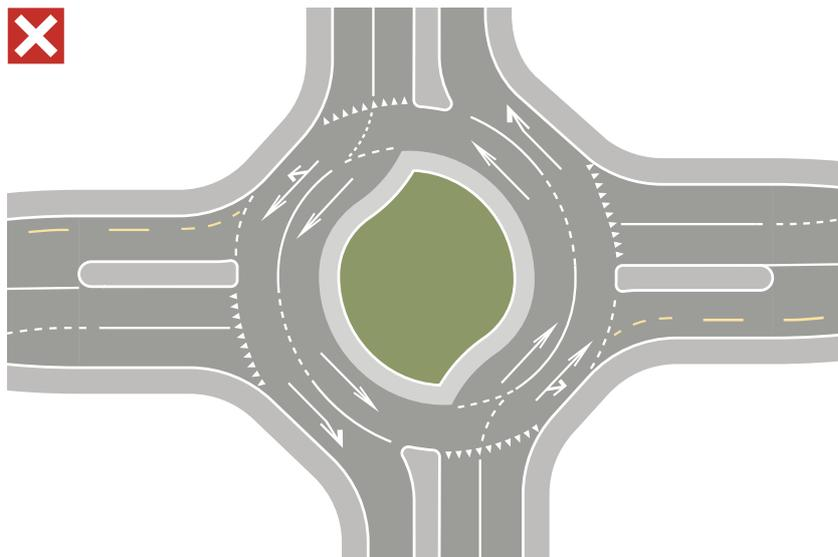
Fig. 631 Le turborotatorie sono troppo complesse anche per i conducenti dei veicoli a motore, pertanto non sono ciclocompatibili
