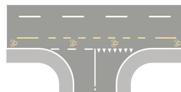
Fig. 417 Soluzione più semplice: evitare la corsia per la svolta a destra (cfr. cap. 4.3.2)
