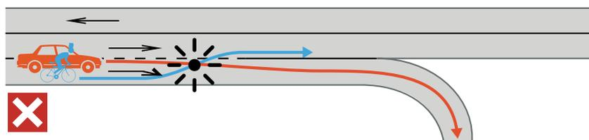
Fig. 419 Da evitare assolutamente: la corsia per proseguire dritto può essere raggiunta solo con una manovra di svolta a sinistra
