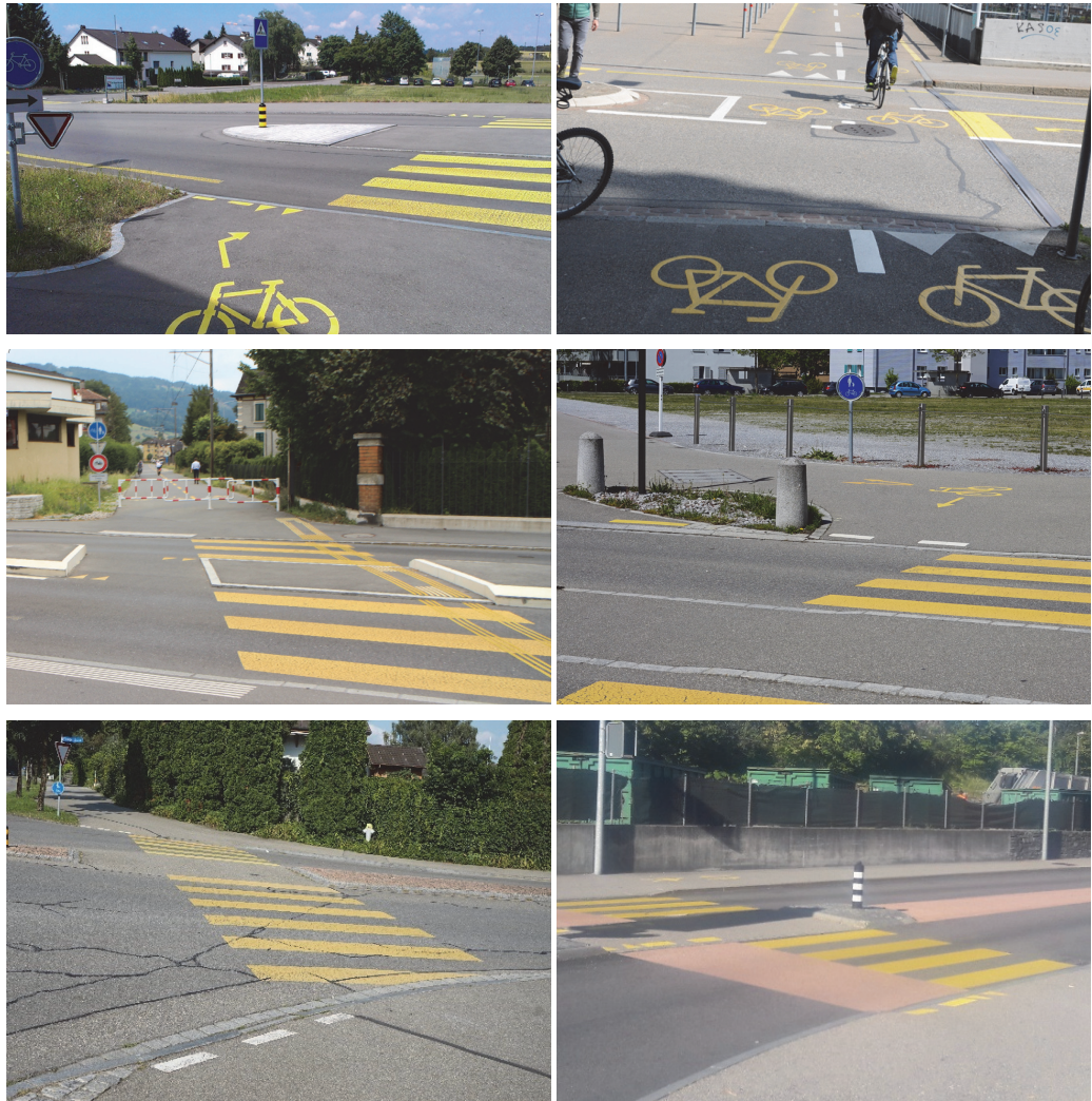
Abbildung 35: Unterschiedliche Ausgestaltungen der vortrittsbelasteten Velofurten in der Schweiz
