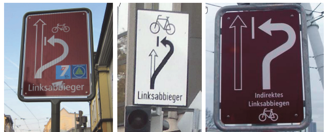
Abbildung 57: Unterschiedliche Vorsignale für indirektes Linksabbiegen in der Schweiz
