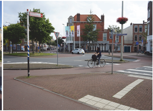
Abbildung 31: Kreisverkehr 22 m Durchmesser mit umlaufendem Radweg
