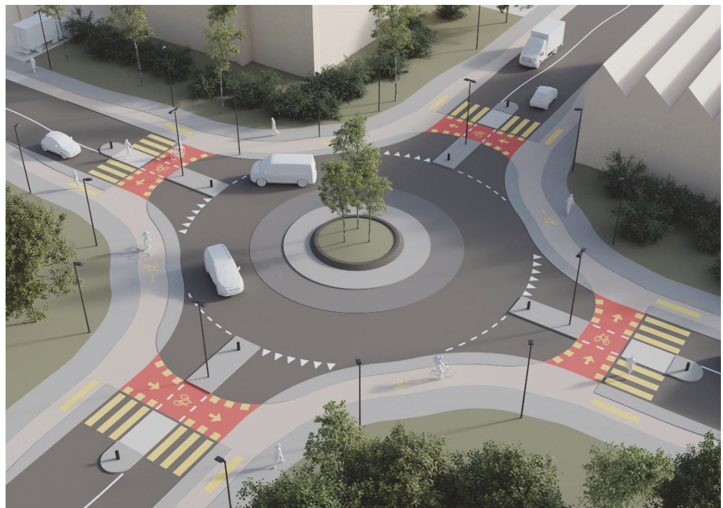
Abbildung 92: Platzoptimierte Variante mit Radwegführung nahe Kreisfahrbahn
