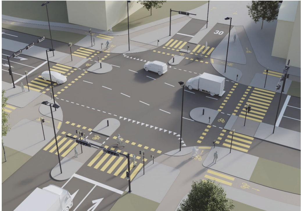
Abbildung 104: LSA-Kreuzung mit umlaufendem Radweg mit vortrittsberechtigter Furtmarkierung
