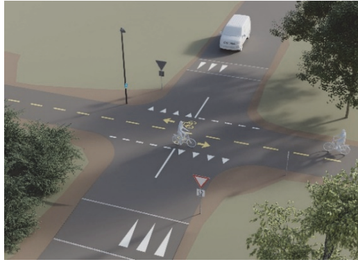
Abbildung 72: Standard ohne Fußgängerführung längs des Radwegs
