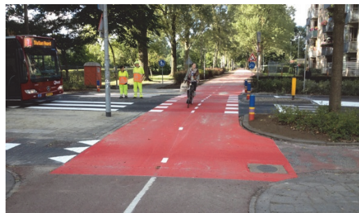
Abbildung 10: Ausgestaltung von Radweg mit Roteinfärbung und Blockmarkierung
