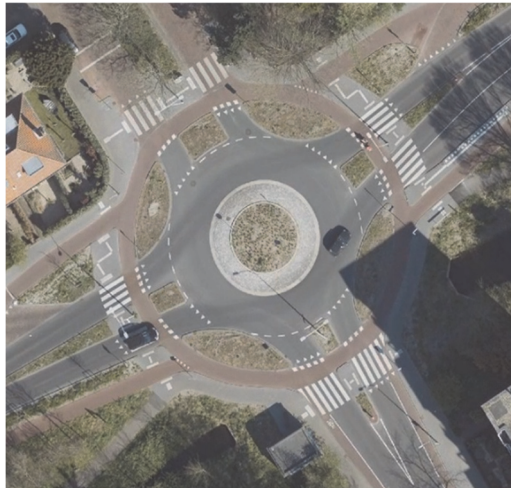
Abbildung 23: Kreisel im Einrichtungsverkehr, Kreiseldurchmesser Fahrbahn 26 m
