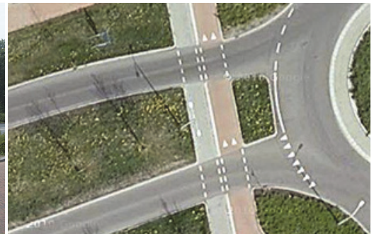
Abbildung 39: Ausgestaltung Velofurt ohne Vortritt mit Führungslinie
