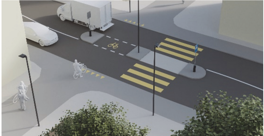
Abbildung 98: Standard für Grundelement C Veloquerung ohne Vortritt
