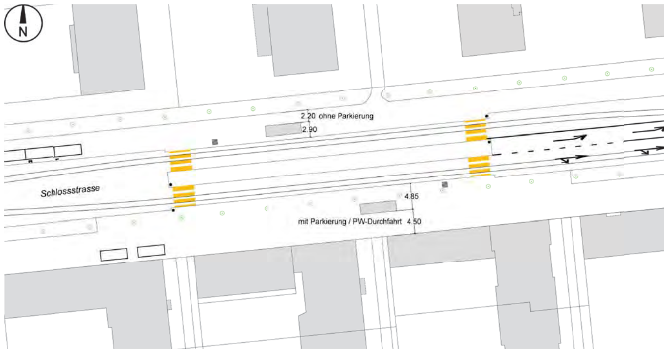
Beispielabmessungen Haltestelle Schlossmatte
