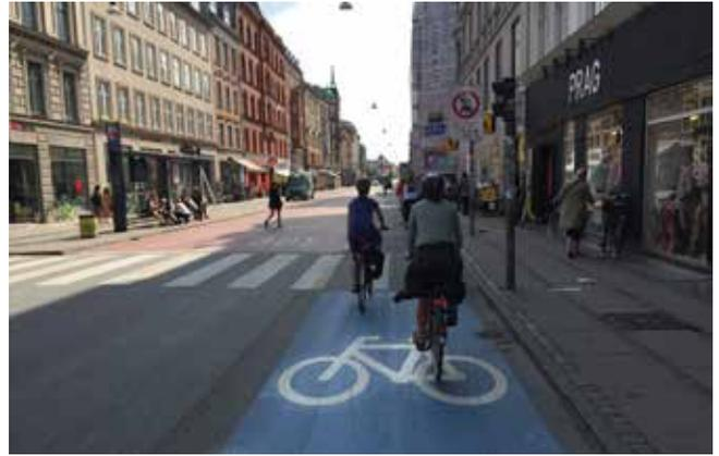
Fig. 6 : Arrêt sur chaussée (flot bus) avec un contournement pour les vélos aux dimensions généreuses et une vitesse limitée à 40 km/h
