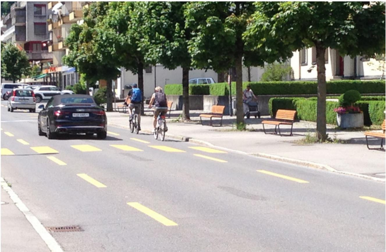
Fig. 9: Voie centrale banalisée à Hergiswil (Photo : Viaplan AG)
