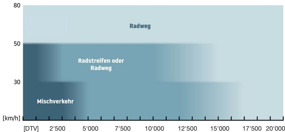
Grafik: Führungsformen des Veloverkehrs in Abhängigkeit von der Verkehrsmenge des motorisierten Verkehrs und der signalisierten Höchstgeschwindigkeit
