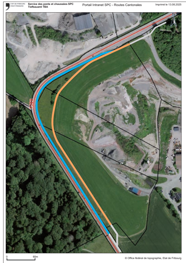
Zwei Varianten wurden für den geplanten Veloweg zwischen Villars-sur-Glâne und Posieux mit dem Landwirt diskutiert: das Anlegen eines Velowegs entlang der Kantonsstrasse (blau) oder das Verbreitern des bestehenden Landwirtschaftswegs (orange). Gewählt wurde die blaue Variante. (Quelle: TBA).
