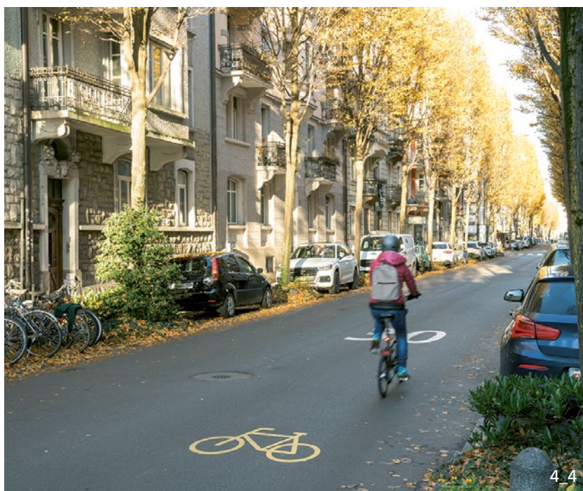
Nel contesto urbano, le superciclabili si sovrappongono spesso a «strade ciclabili» compatibili con le realtà dei quartieri. Tracciato e direzione sono indicati mediante l'uso coordinato di segnaletica orizzontale e verticale (Bruchstrasse, Lucerna).
