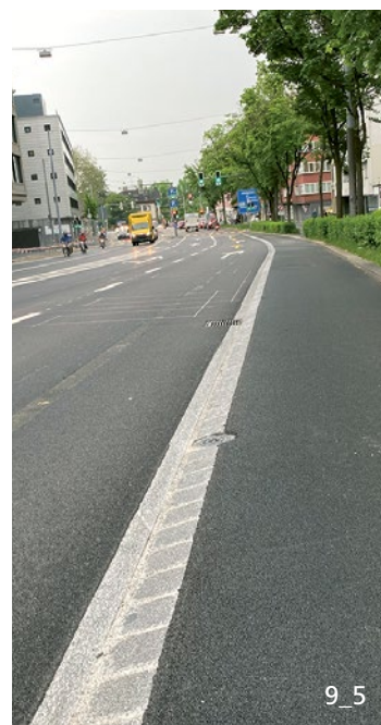
Cordolo inclinato tra la carreggiata e la pista ciclabile unidirezionale (Murtenstrasse, Berna)
