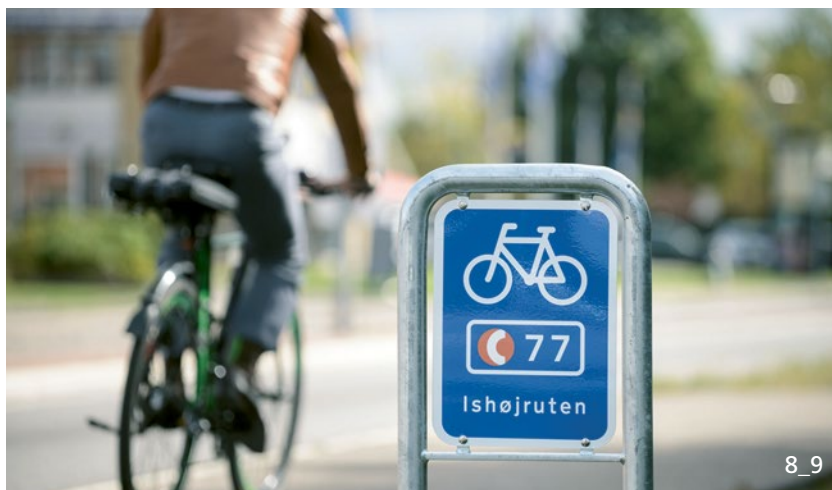
Segnaletica verticale indicante una superciclabile (area di Copenhagen, Danimarca) N.B.: la «C» su fondo arancio è segnalata anche sulla carreggiata per una migliore riconoscibilità del tracciato (non prevista nel diritto della circolazione stradale svizzero).
