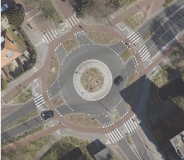
Kreisel mit umlaufendem Radweg, Niederlande
