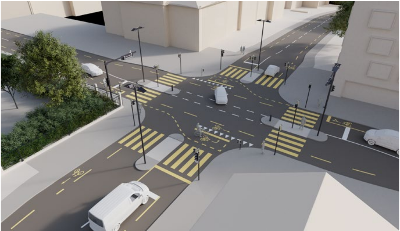
Abb. 7: Mit der Führungslinie zum Aufstellbereich wird die intuitive Nutzung verbessert.
