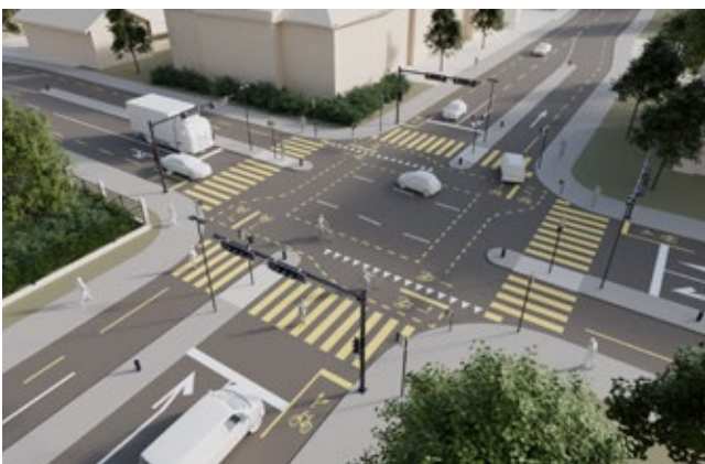
Abb. 8: Varianten zur Ausgestaltung des indirekten Linksabiegens als Knotensystem, Entwurf Schweiz
