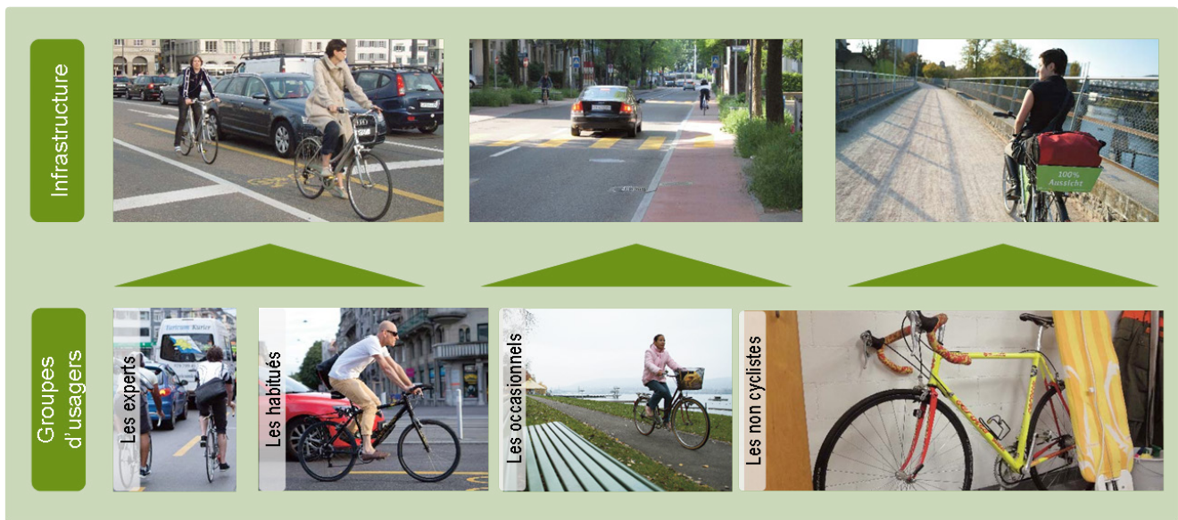
Figure: Afin d'inciter un plus grand nombre d'occasionnels et de non cyclistes à utiliser leur vélo, une infrastructure plus attrayante doit leur être proposée. Alors qu'une bande cyclable standard de 1.50 m de large convient parfaitement aux experts et aux habitués, elle ne répond pas aux besoins de sécurité des autres groupes d'utilisateurs. Ces derniers ont en effet des attentes extrêmement élevées en ce qui concerne la qualité des itinéraires cyclables.
