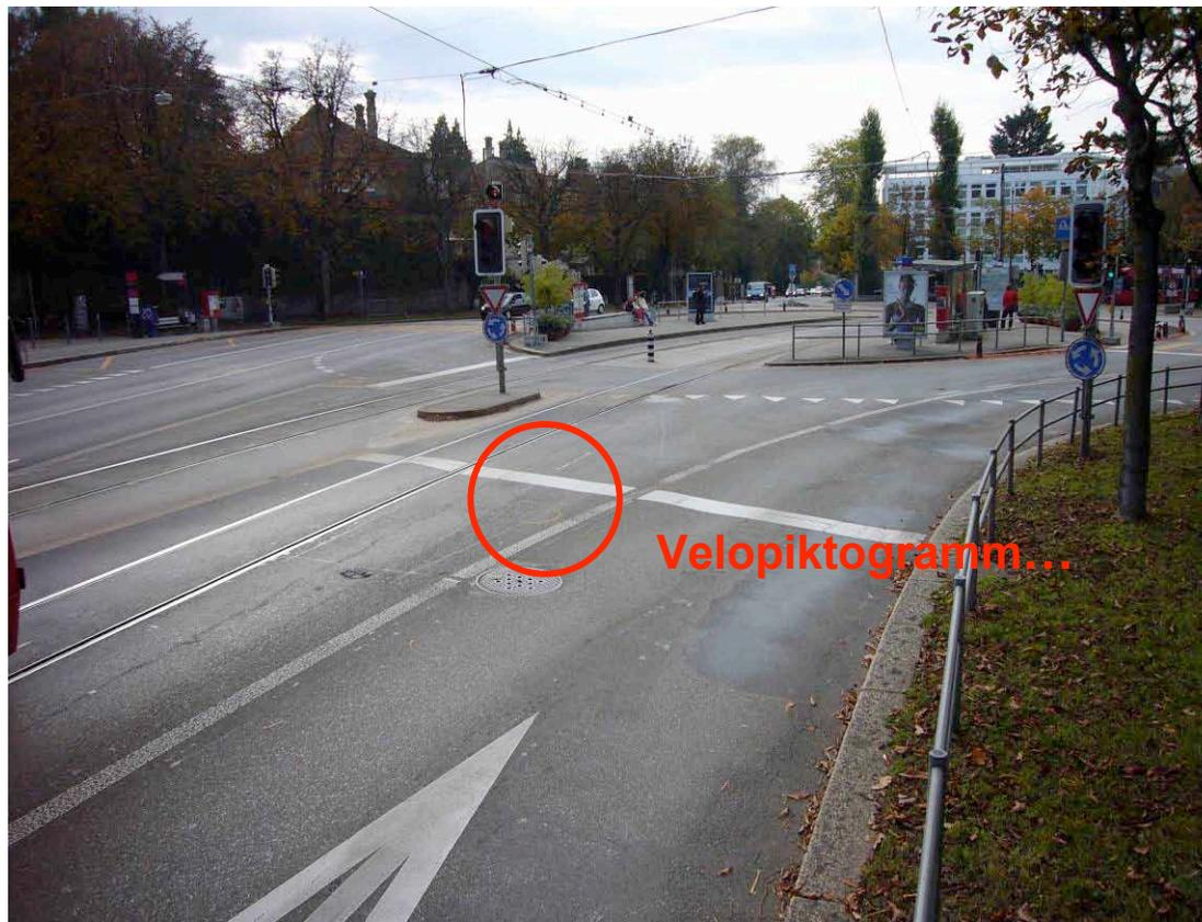
Kreisel mit zweispurigen Zufahrten sind für den Veloverkehr sehr gefährlich. Die beiden Fahrspuren führen zu verschiedenen Zielen. Um in die linke Fahrspur zu gelangen müssen Velofahrende die dicht befahrende rechte Spur queren.
