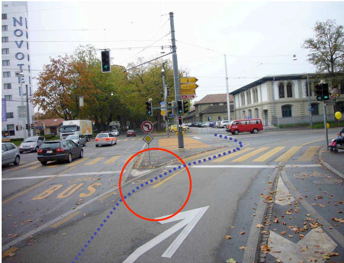
Der Veloverkehr wird in der Zufahrtsstrecke auf dem Trottoir geführt. Linksabbiegen ist untersagt. Um in den Wartebereich für das indirekte Linksabzubiegen zu gelangen, muss unmittelbar nach der Rückführung auf die Fahrbahn die Rechtsabbiegespur gequert werden.
