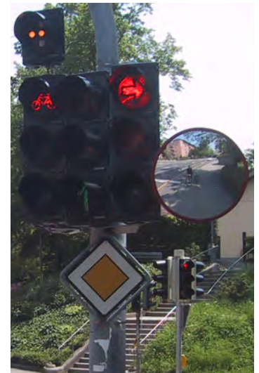
TRIXI - Spiegel zur Vermeidung von Unfällen beim Rechtsabbiegen.
