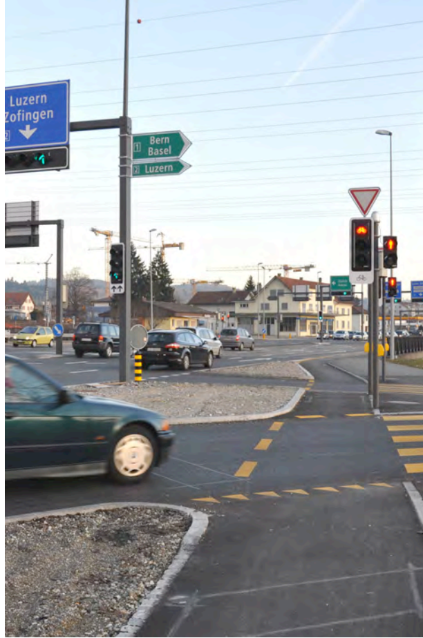
Getrennte Führung mit Radweg und Lichtsignalsteuerung über die Ein- und Ausfahrt der HLS.
