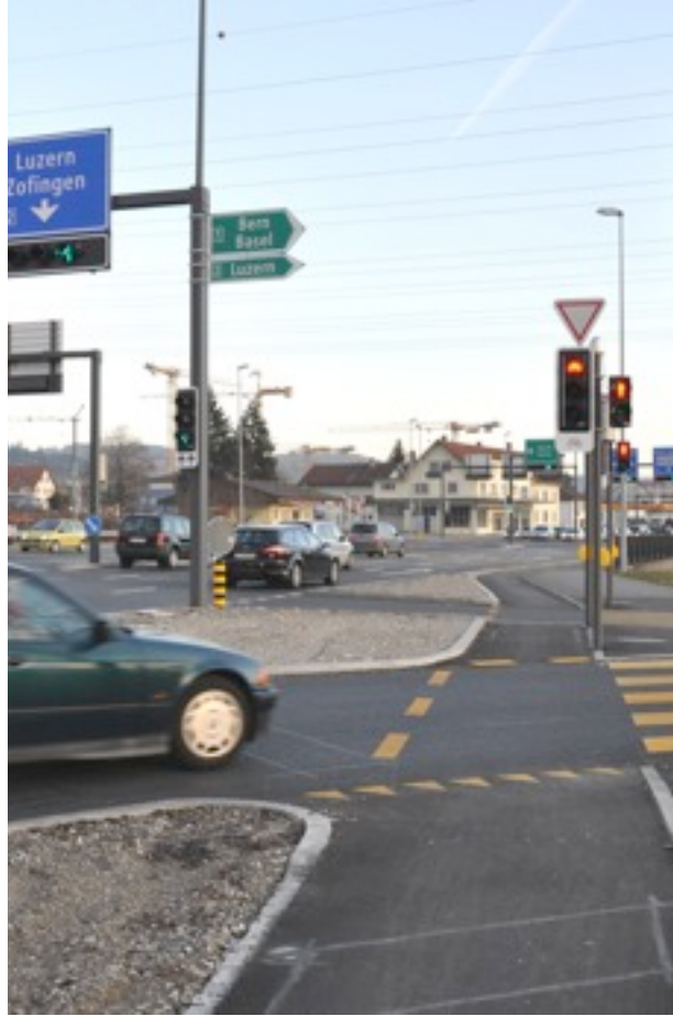
Cycles hors de la circulation motorisée, piste cyclable, traversée régulée des voies d'entrée et de sortie de la RGD.
