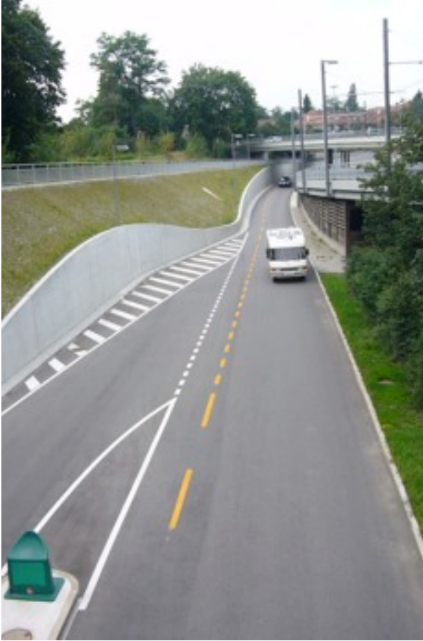
Cycles intégrés à la circulation motorisée, bande cyclable continue, voie de présélection pour le tourner-à-droite en direction de la RGD.
