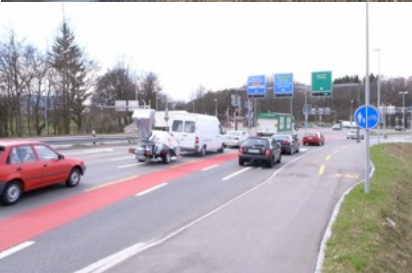
Bande cyclable continue et clairement visible pour les cyclistes aguerris, piste cyclable sur trottoir comme alternative pour les cyclistes moins expérimentés. A noter: la voie de présélection pour le tourner-à-droite en direction de la RGD.
