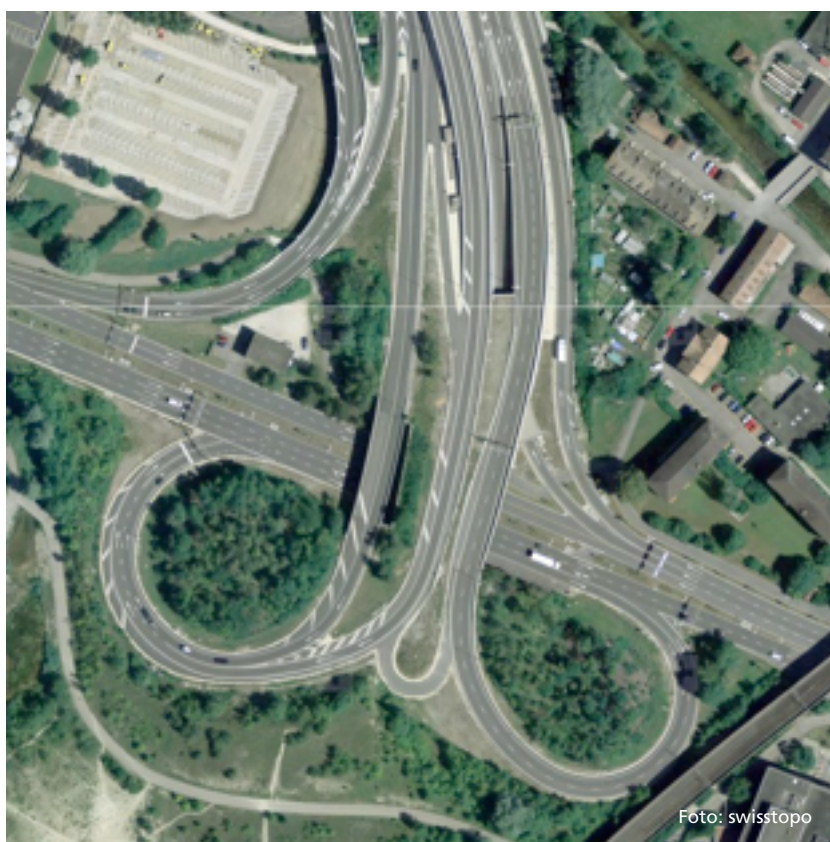
Jonction dénivelée et franchissement séparé de la jonction pour les cycles (contournement)
