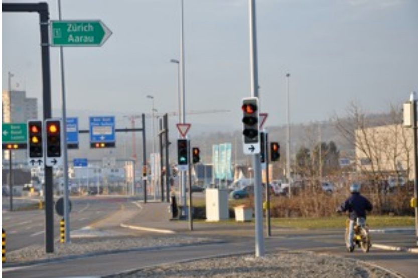
Cycles hors de la circulation automobile et régulation lumineuse de la traversée de l'entrée d'autoroute
