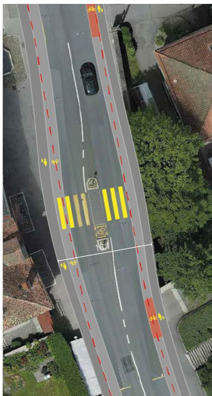
Abb. 1-3: Die Stadt Freiburg macht auf der Murtenstrasse mit den durchgehenden 1,30 m breiten Velostreifen bei einer totalen Breite der Fahrspur von 3,30 m gute Erfahrungen, auch wenn das noch nicht der Wunschzustand ist. (Fotos: Stadt Freiburg)
