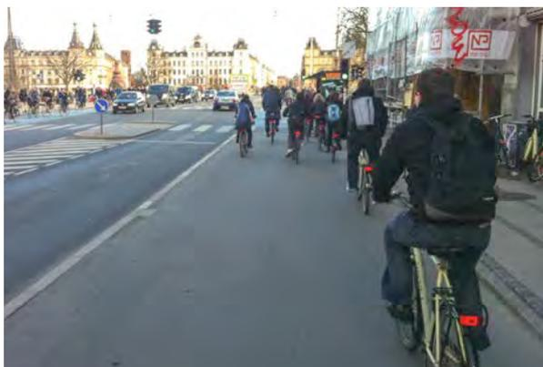
Rouler côte à côte et se dépasser nécessite de la place (piste cyclable unidirectionnelle, Danemark)
